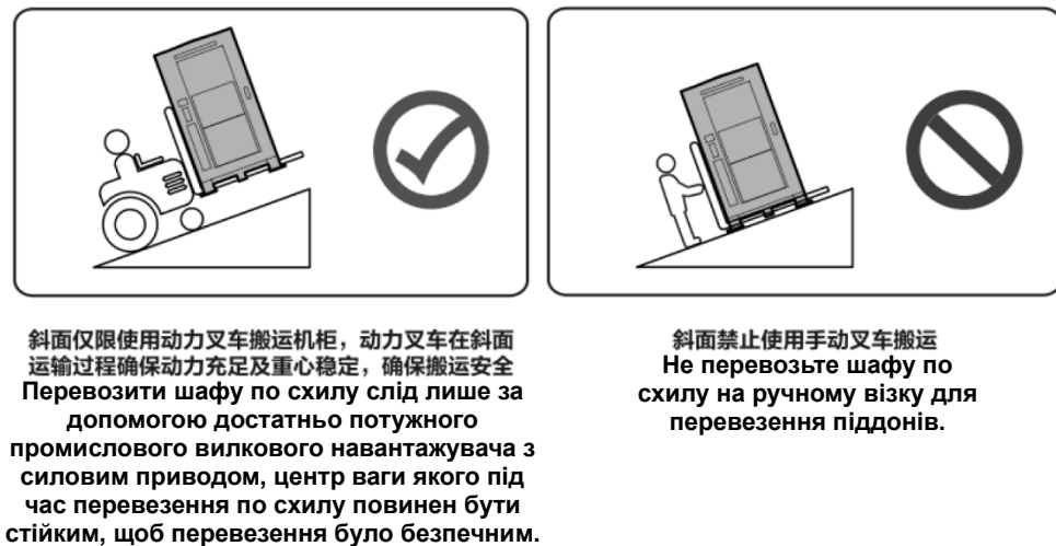
Рисунок 3-2 Перевезення шафи по схилу за допомогою вилкового навантажувача
