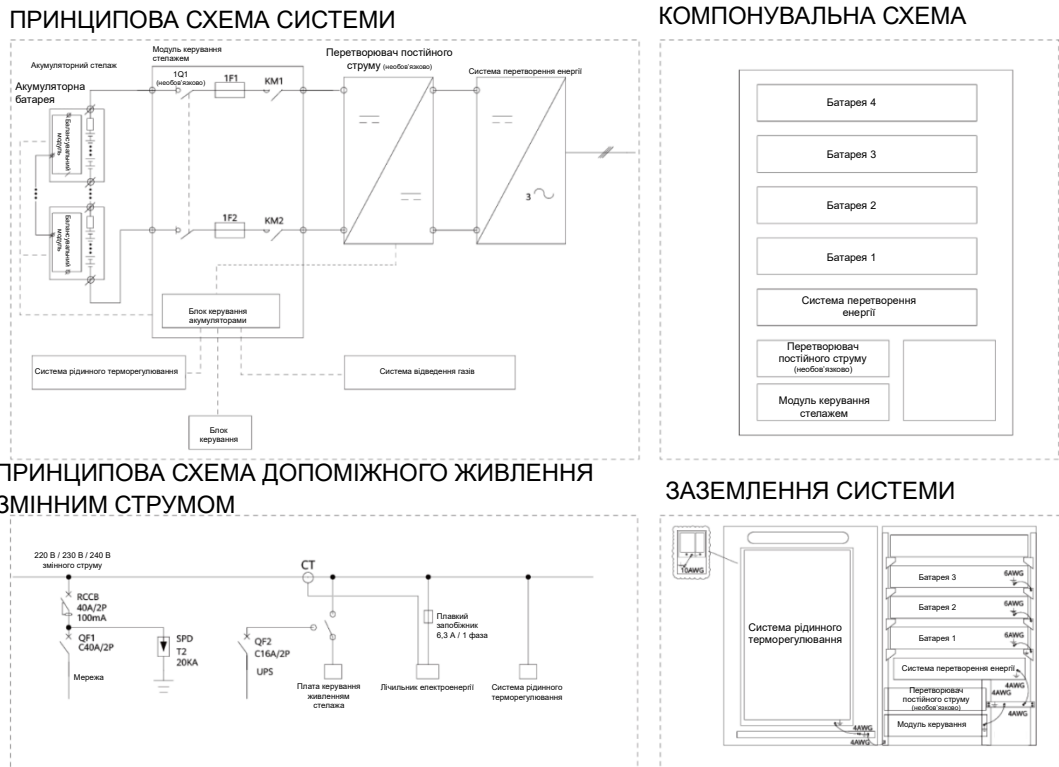
Рисунок 2-26 Принципова електрична схема (з перетворювачем постійного струму (DCDC))
