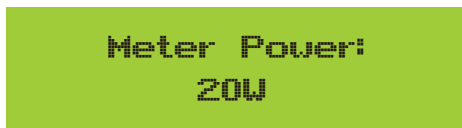
Рис. 7.36 Функція нульового експорту через увімкнення лічильника електроенергії
